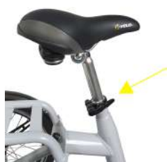
Zadelhoogte via snelspanner met behulp van hendel
