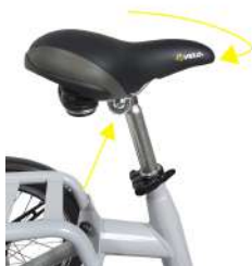
Zadelhoogte via snelspanner met behulp van hendel
