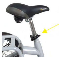
Zadelhoogte via snelspanner met behulp van hendel
