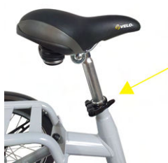
Zadelhoogte via snelspanner met behulp van hendel
