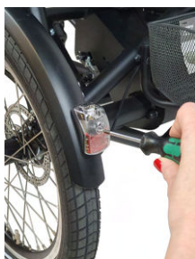
Draai kruiskop-schroef open
