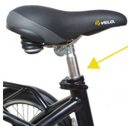
Zadelhoogte via snelspanner met behulp van hendel
