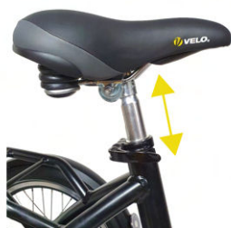
Zadelhoogte via snelspanner met behulp van hendel
