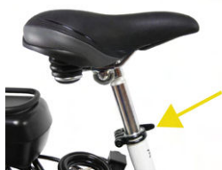
Zadelhoogte via snelspanner met behulp van hendel
