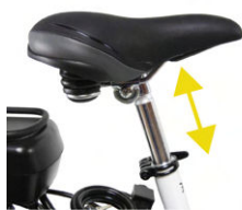
Zadelhoogte via snelspanner met behulp van hendel
