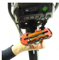
Neem het achterlicht af en vervang batterijen
