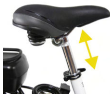
Zadelhoogte via snelspanner met behulp van hendel
