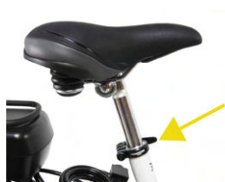
Zadelhoogte via snelspanner met behulp van hendel
