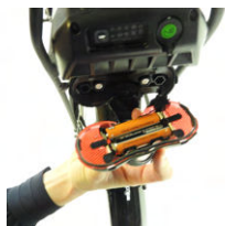
Neem het achterlicht af en vervang batterijen
