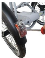
Draai kruiskop-schroef open
