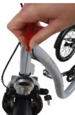
Draai inbus-schroef open
