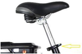
Zadelhoogte via snelspanner met behulp van hendel
