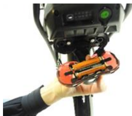
Neem het achterlicht af en vervang batterijen
