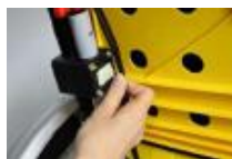
Remove brake cable
